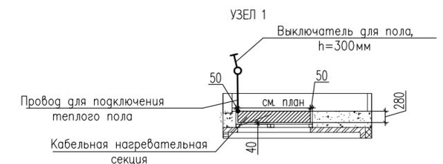
1. Нагревательные секции укладывать в стяжку пола в местах указанных на схеме при соблюдении размеров. Шаг укладки  $0,07$  м.
